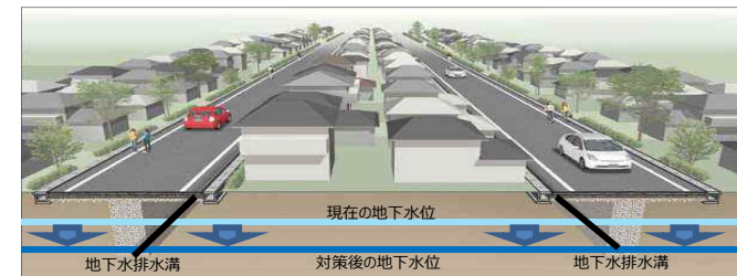
道路と宅地との一体的な液状化対策を行う工法のイメージ（地下水位低下工法）
